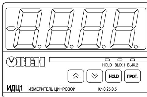
**Рисунок 6.2 – Внешний вид лицевой панели прибора**
