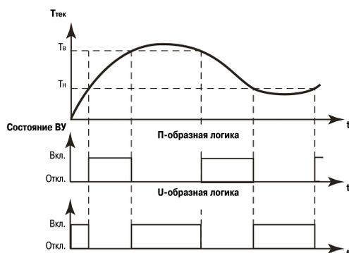
**Рисунок 7.3 – Типы логики при работе ЛУ**
