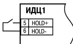
Рисунок 5.4 – Схема подключения коммутирующего устройства к прибору
