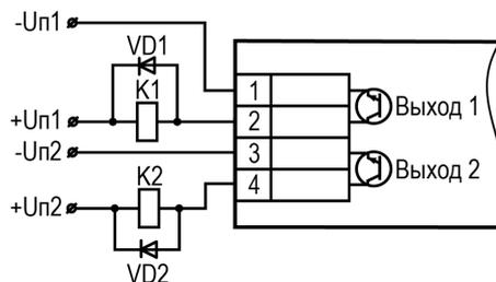
Рисунок 5.3 – Схема подключения реле к прибору
