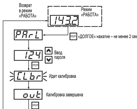
Рисунок 8.1 – Меню калибровки прибора
