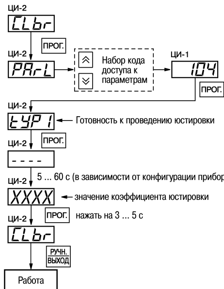
Рисунок 8.2 – Схема проведения юстировки прибора для работы с первичным преобразователем
