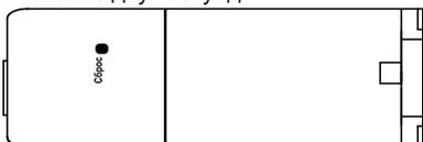
**Рисунок 3 – Кнопка «Сброс» на нижней стороне корпуса**
