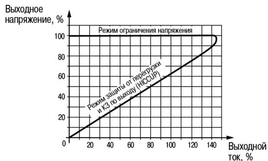
Рисунок 5 - График зависимости выходного напряжения от выходного тока
