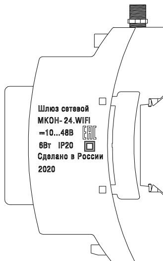
Рисунок 1 – Маркировка на правой стороне корпуса
