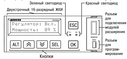
Рисунок 14 – Лицевая панель прибора (крышка отсека подключения модулей условно не показана)
