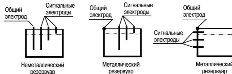
Рисунок 12 – Примеры установки кондуктометрических зондов
