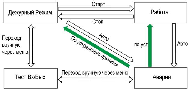
Рисунок 8.1 – Блок-схема перехода между режимами работы
