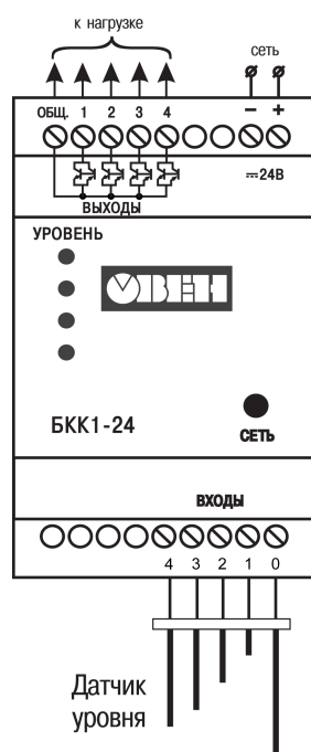
Рисунок 5.3 – Схема подключения БКК1-24
