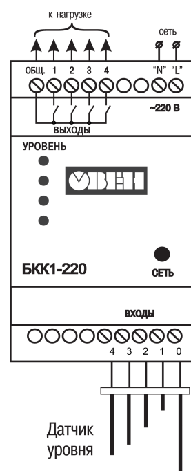
Рисунок 5.4 – Схема подключения БКК1-220
