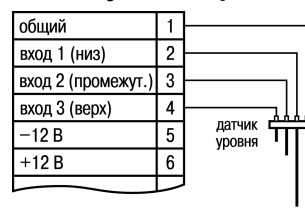
Рисунок 7 – Схема подключения кондуктометрических датчиков уровня
