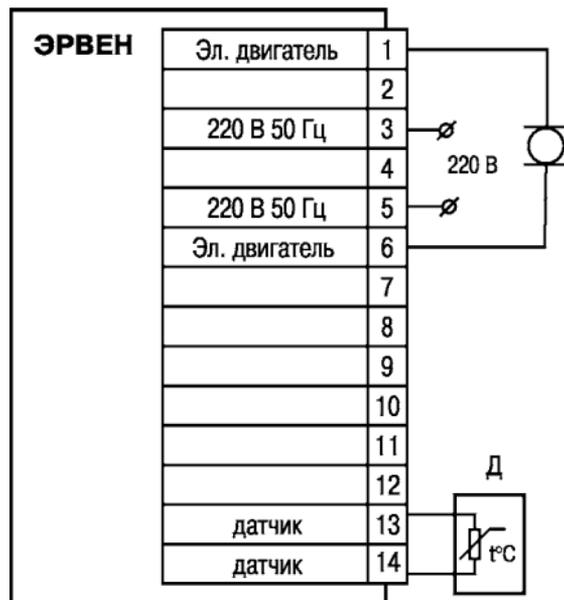
Рис. Б.1 – Схема подключения прибора
