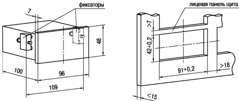
Рисунок А.1 – Габаритные и установочные размеры прибора
