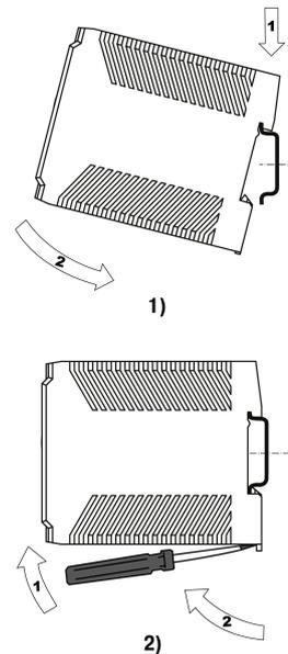
Рисунок 2 - Монтаж (1) и демонтаж (2) прибора
