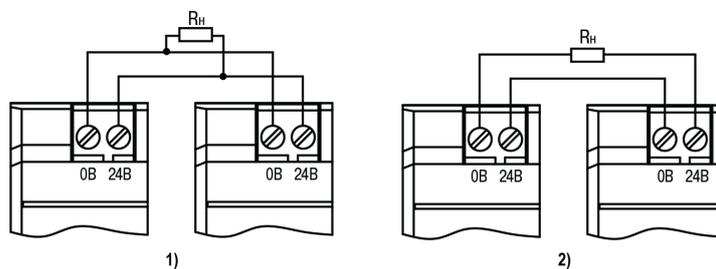
Рисунок 3 - Схема параллельного (1) и последовательного (2) подключения нескольких приборов
