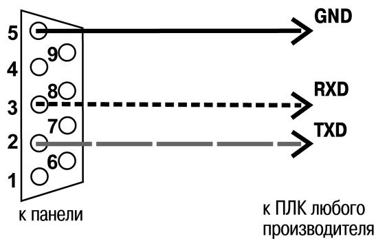
Рисунок В.4 - Соединительный кабель для связи панели ИП320 и ПЛК лю-
