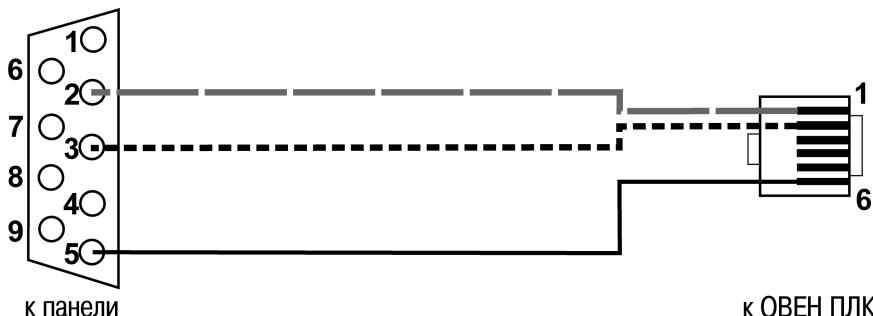
Рисунок В.3 - Соединительный кабель для связи
