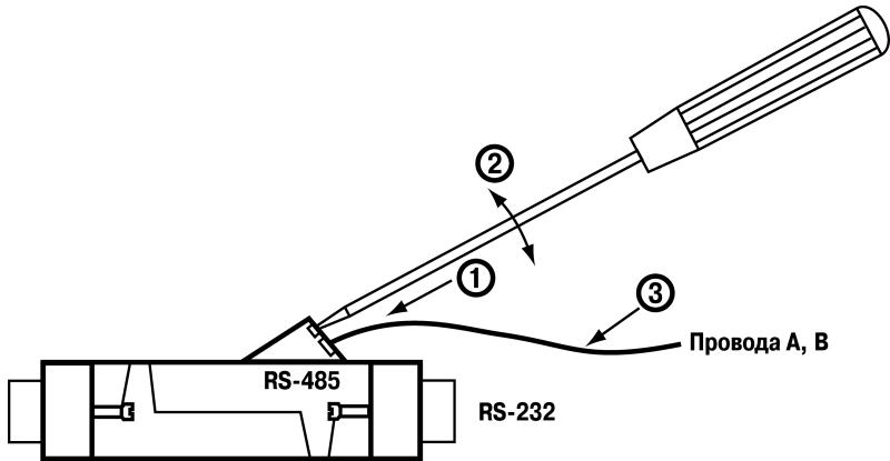
**Рисунок 4.1 - Подключение проводов А и В к переходнику**
