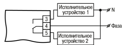
Рисунок 13 – Схема подключения нагрузки к ВУ типа Р
