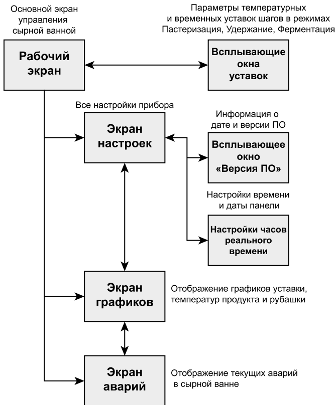
Рисунок 8.5 – Схема переходов между экранами панели
