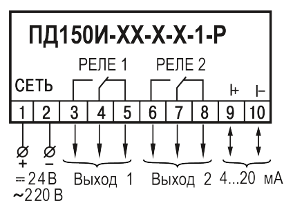
Рисунок 5.2 – Назначение контактов клеммника преобразователя с аналоговым выходом
