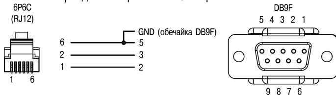
Рисунок В.4 – Кабель KC2 для подключения ПЛК150 к панелям ИП320, СП270 и СП3хх (порт RS-232 Debug)
