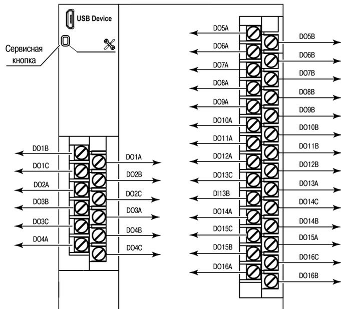
Рисунок 1 – Назначение контактов клемника
