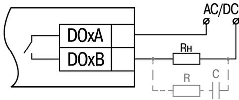
Рисунок 2 – Схема подключения внешних связей к дискретным выходам с 5 по 12 с NO контактами
