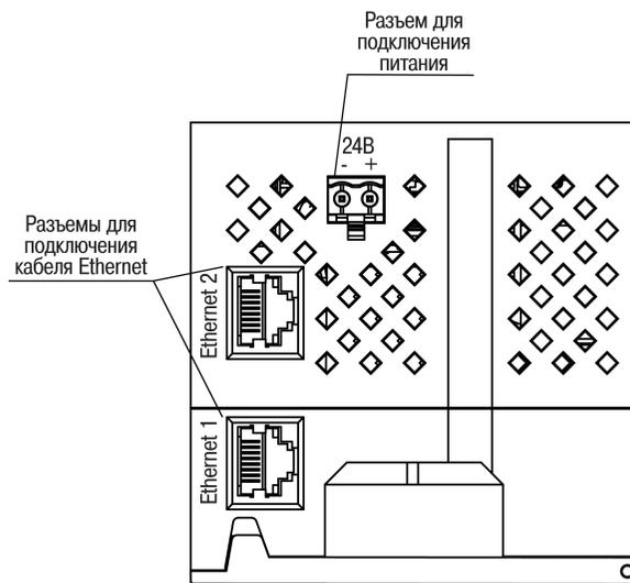
Рисунок 4 – Разъемы прибора
